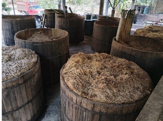
Figura 5. Tinas de madera para fermentación
