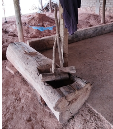
Figura 3. Mazo para moler agave cocido
